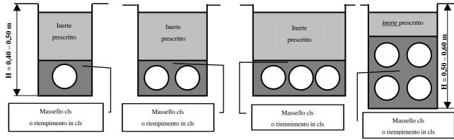
**Nota:** Nella sezione a tubi sovrapposti, il tubo superiore deve rispettare la profondità minima prevista nella canalizzazione di riferimento.
